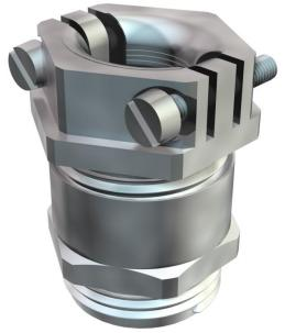
Kabelverschraubung mit zentrisch wirkender Querbügel-Zugentlastung in der Druckschraube, Biegeschutz beweglicher Leitungen durch stark gerundete Druckschraube. Mit PG-Anschlussgewinde nach DIN 40430. Druckringe Stahl, galvanisch verzinkt und transparent passiviert. Dichtring aus NR/SBR. Schutzart: mit Anschlussgewinde-Dichtring IP65, ohne Anschlussgewinde-Dichtring IP54 Mit Sechskant-Zwischenstutzen (ähnlich Form C 4 nach DIN 46320). \* Preise laut DEL-Notierung.
