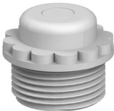
Mit Durchstoßmembrane, hierbei ist die Öffnung D vorgeprägt, aber zunächst verschlossen. Würgedichtung zum Einschrauben in metrische Gewinde nach IEC 423. Mit selbstdichtendem Konus am Gewindeende, daher kein Anschlussgewindedichtring erforderlich. Erreichbare Schutzart bei sorgfältiger Montage IP54.
