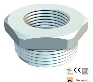
Reduktion mit PG-Innen- und -Außengewinde nach DIN 40430 für die Montage von Kunststoff-Kabelverschraubungen an Gehäusen. Schutzart IP54 ohne zusätzliche Anschlussdichtung. Schutzart bis IP68 möglich mit zusätzlicher Anschlussdichtung, zum Beispiel O-Ring oder Flachdichtring.
