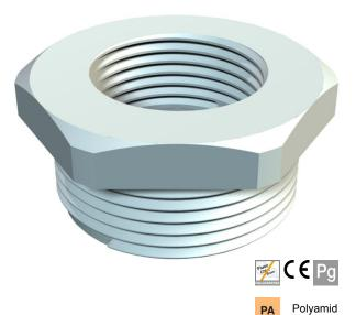
Reduktion mit PG-Innen- und -Außengewinde nach DIN 40430 für die Montage von Kunststoff-Kabelverschraubungen an Gehäusen. Schutzart IP54 ohne zusätzliche Anschlussdichtung. Schutzart bis IP68 möglich mit zusätzlicher Anschlussdichtung, zum Beispiel O-Ring oder Flachdichtring.
