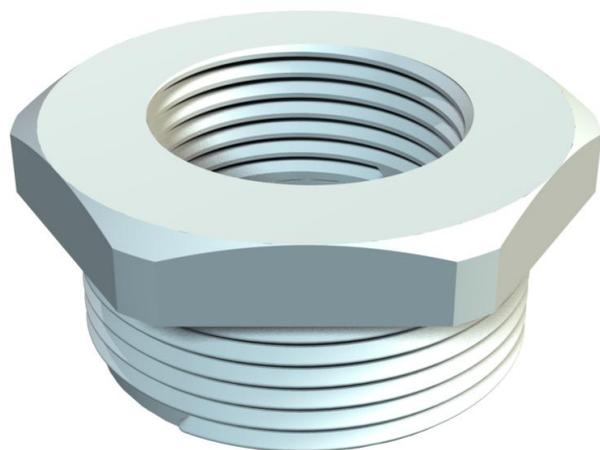
Reduktion mit metrischem Innen- und Außengewinde für die Montage von Kunststoff-Kabelverschraubungen an Gehäusen. Schutzart IP54 ohne zusätzliche Anschlussdichtung. Schutzart bis IP68 möglich mit zusätzlicher Anschlussdichtung, zum Beispiel O-Ring oder Flachdichtring.
