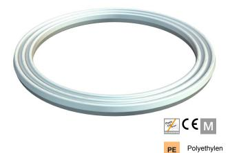
Anschlussgewinde-Dichtring geeignet für alle Kabelverschraubungen aus Kunststoff mit metrischem Anschlussgewinde nach DIN EN 60423 bzw. ISO 68. Die Innendurchmesser der Dichtringe sind so ausgelegt, dass diese unverlierbar vormontiert werden können.
