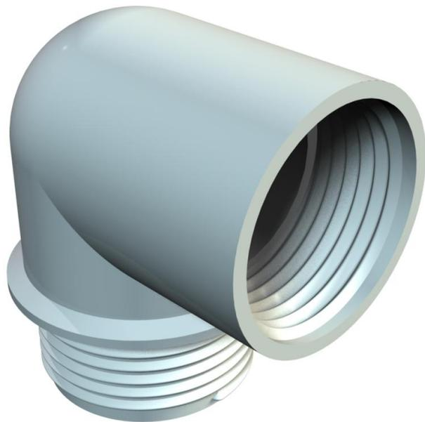
Winkelstutzen mit PG-Innen- und -Außengewinde nach DIN 40430. Der Winkelstutzen kann mit 2 Druckringen 107/D aus Stahl, einem Dichtring 107/A oder 107/B und einer Druckschraube 107/E zu einer Winkelverschraubung komplettiert werden.
