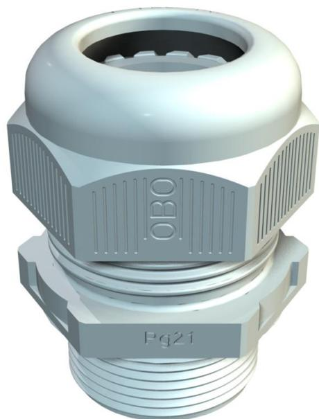
Kabelverschraubung mit PG-Anschlussgewinde in Hutmutterbauart, für Kabelabzweiggästen, Gehäuse, Verteilerkästen im privaten und industriellen Bereich. Mit Zugentlastung und integrierter Dichtlippe, geprüft nach DIN EN 62444. Schutzklasse IP68. Einsetzbar von -20°C bis +65°C.
