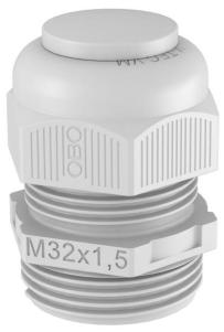
Kabelverschraubung mit metrischem Anschlussgewinde in Hutmutterbauart, für Kabelabzweigkästen, Gehäuse, Verteilerschränke im privaten und industriellen Bereich. Mit Zugentlastung und integrierter Dichtlippe, geprüft nach DIN EN 62444. Schutzklasse IP68. Einsetzbar von -20°C bis +65°C
