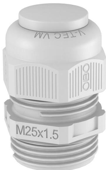
Kabelverschraubung mit metrischem Anschlussgewinde in Hutmutterbauart, für Kabelabzweiggästen, Gehäuse, Verteilerschränke im privaten und industriellen Bereich. Mit Zugentlastung und integrierter Dichtlippe, geprüft nach DIN EN 62444. Schutzklasse IP68. Einsetzbar von -20°C bis +65°C. Hiermit ist ein problemloses Verschließen nicht benötigter Öffnungen möglich. Es kann kein Staub oder Wasser eindringen und die Schutzart bleibt erhalten.
