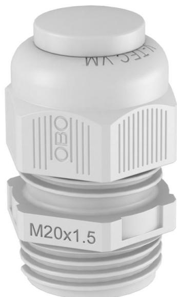
Kabelverschraubung mit metrischem Anschlussgewinde in Hutmutterbauart, für Kabelabzweiggästen, Gehäuse, Verteilerschränke im privaten und industriellen Bereich. Mit Zugentlastung und integrierter Dichtlippe, geprüft nach DIN EN 62444. Schutzklasse IP68. Einsetzbar von -20°C bis +65°C. Hiermit ist ein problemloses Verschließen nicht benötigter Öffnungen möglich. Es kann kein Staub oder Wasser eindringen und die Schutzart bleibt erhalten.
