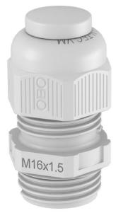
Kabelverschraubung mit metrischem Anschlussgewinde in Hutmutterbauart, für Kabelabzweigkästen, Gehäuse, Verteilerschränke im privaten und industriellen Bereich. Mit Zugentlastung und integrierter Dichtlippe, geprüft nach DIN EN 62444. Schutzklasse IP68. Einsetzbar von -20°C bis +65°C
