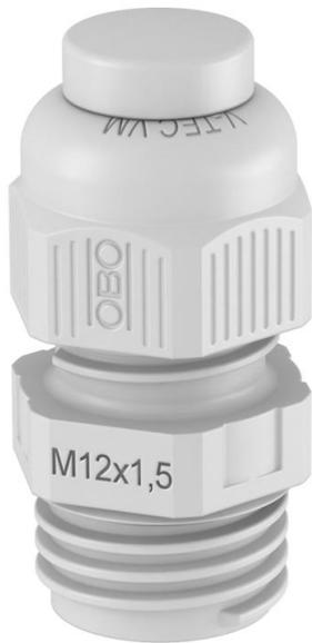
Kabelverschraubung mit metrischem Anschlussgewinde in Hutmutterbauart, für Kabelabzweiggästen, Gehäuse, Verteilerschränke im privaten und industriellen Bereich. Mit Zugentlastung und integrierter Dichtlippe, geprüft nach DIN EN 62444. Schutzklasse IP68. Einsetzbar von -20°C bis +65°C. Hiermit ist ein problemloses Verschließen nicht benötigter Öffnungen möglich. Es kann kein Staub oder Wasser eindringen und die Schutzart bleibt erhalten.
