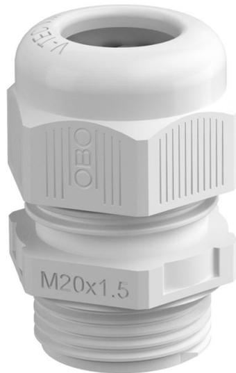
Kabelverschraubung mit metrischem Anschlussgewinde in Hutmutterbauart, für Kabelabzweiggästen, Gehäuse, Verteilerschränke im privaten und industriellen Bereich. Mit Zugentlastung und integrierter Dichtlippe, geprüft nach DIN EN 62444. Schutzklasse IP68. Einsetzbar von -20°C bis +65°C.
