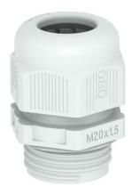
Kabelverschraubung mit metrischem Anschlussgewinde in Hutmutterbauart, für Kabelabzweigkästen, Gehäuse, Verteilerschränke im privaten und industriellen Bereich. Mit Zugentlastung und integrierter Dichtlippe, geprüft nach DIN EN 62444. Schutzklasse IP68. Einsetzbar von -20°C bis +65°C. Inklusive Gegenmutter.
