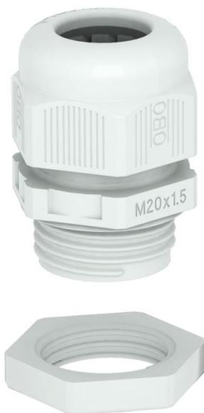
Kabelverschraubung mit metrischem Anschlussgewinde in Hutmutterbauart, für Kabelabzweiggästen, Gehäuse, Verteilerschränke im privaten und industriellen Bereich. Mit Zugentlastung und integrierter Dichtlippe, geprüft nach DIN EN 62444. Schutzklasse IP68. Einsetzbar von -20°C bis +65°C. Inklusive Gegenmutter.
