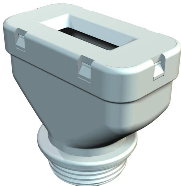
Flachkabeleinführung in Würfenippelbauart, mit metrischem Anschlussgewinde nach IEC 432, Schutzart IP31, mit vormontiertem Stützendichtring 107/F.
