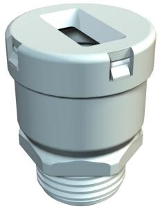
Flachkabeleinführung in Würgenippelbauart, mit PG-Anschlussgewinde nach DIN 40430, Schutzart IP31, mit vormontiertem Stutzendichtring 107/F.
