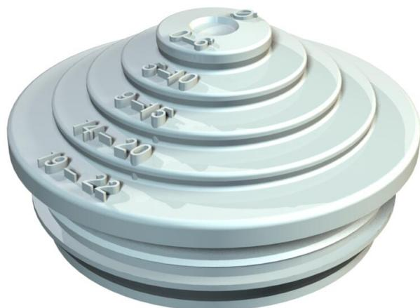
Der Einsteckknippel kann durch stufenweises Abschneiden dem jeweiligen Kabeldurchmesser angepasst werden.
