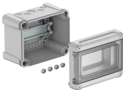
Kleinverteiler zur Aufputz-Montage, für die Strom-Unterverteilung im Innen- und geschützten Außenbereich, gemäß IEC 439-3. Mit vormontierter 35-mm-Hutprofilschiene. Schutzart IP66 und Schutzgrad IK07. Transparenter Deckel zum Schrauben, mit Ausschnitt.
