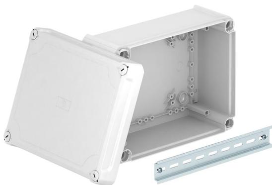
Kabelabzweigkasten geschlossen zum Verbinden von Kabeln und Leitungen im Innenbereich und geschützten Außenbereichen. Rechteckige Form ohne Einführungen. Geeignet für die Wand-/ Deckenmontage, die Montage auf Montageblechen und Gewinde im Boden. Mit der Möglichkeit zur Innenbefestigung und Montage über die Eckdome. Hoher Deckel mit Schnellverschluss, plombierbar. Hergestellt aus halogenfreien und UV-resistenten Materialien. Inklusive Hutprofilschiene.
