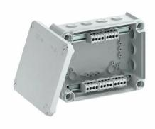
Kabelabzweigkasten mit Klemmleiste zum Verbinden von Kabeln und Leitungen im Innenbereich und geschützten Außenbereichen. Rechteckige Form mit Einsteckdichtungen an den Seiten und Ausschlageinführungen im Boden. Geeignet für die Wand-/ Deckenmontage und die Montage auf Montageblechen. Mit der Möglichkeit zur Innenbefestigung und Montage über die Eckdome. Deckel mit Schnellverschluss, plombierbar. Hergestellt aus halogenfreien und UV-resistenten Materialien.
