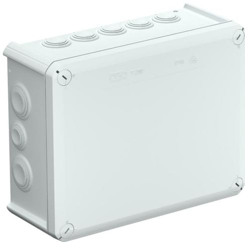
Kabelabzweigkasten zum Verbinden von Kabeln und Leitungen im Innenbereich und geschützten Außenbereichen. Rechteckige Form mit Einsteckdichtungen an den Seiten und Ausschlageinführungen im Boden. Geeignet für die Wand-/ Deckenmontage, die Montage auf Montageblechen und Gewinde im Boden. Mit der Möglichkeit zur Innenbefestigung und Montage über die Eckdome. Deckel mit Schnellverschluss, plombierbar. Hergestellt aus halogenfreien Materialien. Flammwidrige Ausführung aus speziellem Polypropylen.
