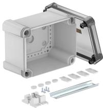
Kabelabzweigkasten mit Hutprofilschiene zum Verbinden von Kabeln und Leitungen im Innen- und Außenbereich. Rechteckige Form ohne Einführungen. Geeignet für die Wand-/ Deckenmontage mit der Möglichkeit zur Außenbefestigung, Innenbefestigung oder Montage über die Eckdome. Besonders schlagfest mit IK09. Transparenter Deckel mit Schnellverschluss, plombierbar. Hergestellt aus halogenfreien und UV-resistenten Materialien.
