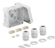
Kabelabzweigkasten mit Klemme zum Verbinden von Kabeln und Leitungen im Innen- und Außenbereich. Quadratische Form mit Ausschlageinführungen. Geeignet für die Wand-/ Deckenmontage mit der Möglichkeit zur Außenbefestigung, Innenbefestigung oder Montage über die Eckdome. Besonders schlagfest mit IK09. Deckel mit Schnellverschluss, plombierbar. Hergestellt aus halogenfreien und UV-resistenten Materialien.
