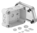
Kabelabzweigkasten zum Verbinden von Kabeln und Leitungen im Innen- und Außenbereich. Rechteckige Form mit Ausschlageinführungen. Geeignet für die Wand-/ Deckenmontage mit der Möglichkeit zur Außenbefestigung, Innenbefestigung oder Montage über die Eckdome. Besonders schlagfest mit IK09. Transparenter Deckel mit Schnellverschluss, plombierbar. Hergestellt aus halogenfreien und UV-resistenten Materialien.
