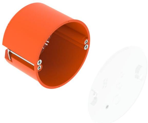
CEE/PERILEX-Hohlwand-Gerätendose mit Deckel, für den Einsatz in Hohlwänden mit einer Einbautiefe von mindestens 61 mm und einer Plattenstärke von 5 - 40 mm.
