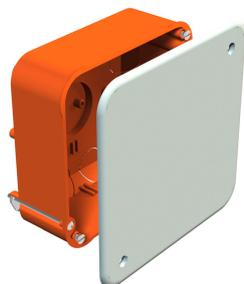
Hohlwand-Verbindungskasten für den Einsatz in Hohlwänden mit einer Einbautiefe von mindestens 50 mm und einer Plattenstärke von 7 - 35 mm. Mit weißem Deckel und Deckelschrauben. Geeignet zum Einbau von Normschienen (Hut- und Tragschienen) für Reihenklemmen.
