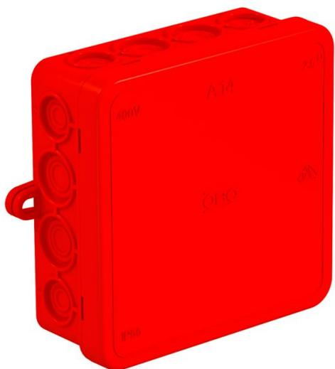
Schutzart IP55, Nennspannung 690 V, Nennquerschnitt 2,5 mm<sup>2</sup>, 8 Einführungen für Kabeldurchmesser 5-14 mm
