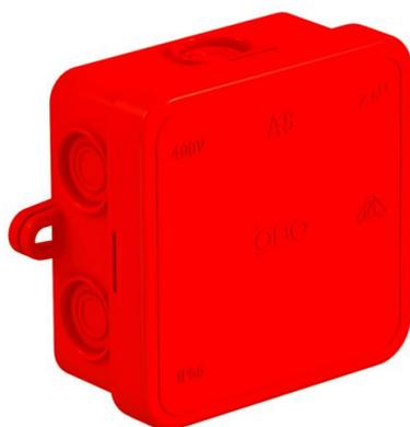
Schutzart IP55, Nennspannung 690 V, Nennquerschnitt 2,5 mm<sup>2</sup>, 7 Einführungen für Kabeldurchmesser 5-14 mm.
