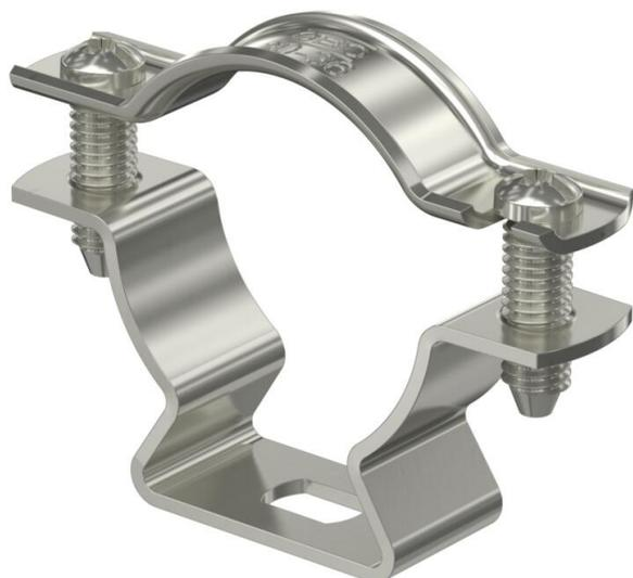
Abstandschelle zur Montage von Rohren und Kabeln an Wand, Decke und Boden. Mit selbstsicherndem Oberteil. Befestigung über Langloch. Zugelassen für den Funktionserhalt nach DIN 4102 Teil 12, Funktionserhaltklassen E 30 bis E 90.
