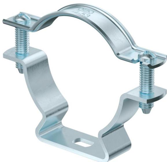
Abstandschele zur Montage von Röhren und Kabeln an Wand, Decke und Boden. Mit selbstsicherndem Oberteil. Befestigung über Langloch. Zugelassen für den Funktionserhalt nach DIN 4102 Teil 12, Funktionserhaltklassen E 30 bis E 90.
