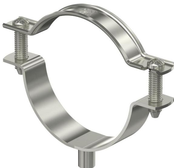
Abstandschelle zur Montage von Rohren und Kabeln an Wand, Decke und Boden. Mit selbstsicherndem Oberteil. Befestigung über Ansatz mit Innengewinde. Oberflächen G und FT ab Schellengröße 20 geeignet für Montage mit Nagelgerät oder Bolzensetzgerät.
