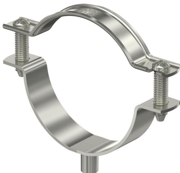
Abstandschele zur Montage von Rohren und Kabeln an Wand, Decke und Boden. Mit selbstsicherndem Oberteil. Befestigung über Ansatz mit Innengewinde. Zugelassen für den Funktionserhalt nach DIN 4102 Teil 12, Funktionserhaltklassen E 30 bis E 90.
