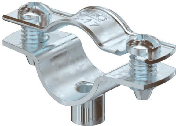
Abstandschele zur Montage von Rohren und Kabeln an Wand, Decke und Boden. Mit selbstsicherndem Oberteil. Befestigung über Ansatz mit Innengewinde. Oberflächen G und FT ab Schellengröße 20 geeignet für Montage mit Nagelgerät oder Bolzensetzgerät. Zugelassen für den Funktionserhalt nach DIN 4102 Teil 12, Funktionserhaltklassen E 30 bis E 90.
