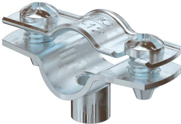
Abstandschelle zur Montage von Rohren und Kabeln an Wand, Decke und Boden. Mit selbstsicherndem Oberteil. Befestigung über Ansatz mit Innengewinde. Oberflächen G und FT ab Schellengröße 20 geeignet für Montage mit Nagelgerät oder Bolzensetzgerät. Zugelassen für den Funktionserhalt nach DIN 4102 Teil 12, Funktionserhaltklassen E 30 bis E 90.
