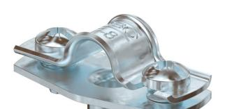
Abstandschelle zur Montage von Rohren und Kabeln an Wand, Decke und Boden. Mit selbstsicherndem Oberteil. Befestigung über Ansatz mit Innengewinde. Oberflächen G und FT ab Schellengröße 20 geeignet für Montage mit Nagelgerät oder Bolzensetzgerät.
