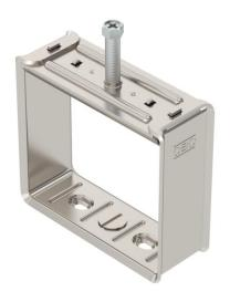
Schelle und Schraube aus Stahl tauchfeuerverzinkt, Senkschraube aus Edelstahl rostfrei, Gleitmutter aus Stahl galvanisch verzinkt. Edelstahlausführung: Schelle, Schraube und Senkschraube aus Edelstahl, rostfrei, Gleitmutter Typ 5019 aus Edelstahl, rostfrei
