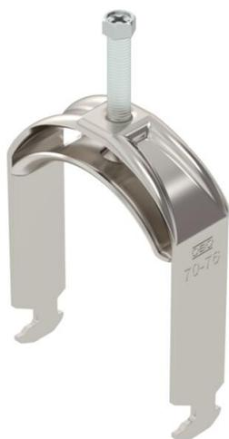
Bügelshelle mit Hammerkopf-Fuß, Metalldruckwanne mit gerundeten Kanten für Kabelschutz. Zur vertikalen und horizontalen Montage von 1 Einzelkabel an C-Profilshiene. Für Schlitzweite 16 - 17 mm. Mit 1-gängiger Schraube an Druckwanne, universeller Sechskant-Schraubenkopf SW10, mit Schlitz und Kreuzschlitz. Geeignet für Montage im Innen- und Außenbereich. Der Einsatz einer Gegenwanne wird empfohlen.
