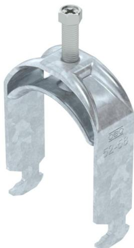
Bügelschelle mit Hammerkopf-Fuß, Metalldruckwanne mit gerundeten Kanten für Kabelschutz. Zur vertikalen und horizontalen Montage von 1 Einzelkabel an C-Profilschiene. Für Schlitzweite 16 - 17 mm. Mit 1-gängiger Schraube an Druckwanne, universeller Sechskant-Schraubenkopf SW10, mit Schlitz und Kreuzschlitz. Geeignet für Montage im Innen- und Außenbereich. Der Einsatz einer Gegenwanne wird empfohlen.
