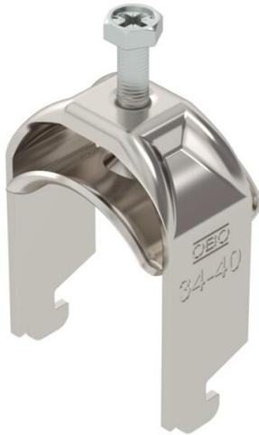
Bügelschelle mit N-Fuß, Metalldruckwanne mit gerundeten Kanten für Kabelschutz. Zur vertikalen und horizontalen Montage von 1 Einzelkabel an C-Profil-schiene. Für Schlitzweite 11 - 12 mm. Mit 1-gängiger Schraube an Druckwanne, universeller Sechskant-Schraubenkopf SW10, mit Schlitz und Kreuzschlitz. Geeignet für Montage im Innen- und Außenbereich. Der Einsatz einer Gegenwanne wird empfohlen.
