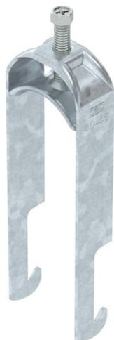
Bügelschelle mit W-Fuß, Metalldruckwanne mit gerundeten Kanten für Kabelschutz. Zur vertikalen und horizontalen Montage von 2 Einzelkabeln an Winkelisen bis < 40 mm. Mit 1-gängiger Schraube an Druckwanne, universeller Sechskant-Schraubenkopf SW10, mit Schlitz und Kreuzschlitz. Geeignet für Montage im Innen- und Außenbereich. Der Einsatz einer Gegenwanne wird empfohlen.
