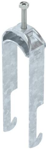
Bügelschelle mit W-Fuß, Metalldruckwanne mit gerundeten Kanten für Kabelschutz. Zur vertikalen und horizontalen Montage von 2 Einzelkabeln an Winkelisen bis < 40 mm. Mit 1-gängiger Schraube an Druckwanne, universeller Sechskant-Schraubenkopf SW10, mit Schlitz und Kreuzschlitz. Geeignet für Montage im Innen- und Außenbereich. Der Einsatz einer Gegenwanne wird empfohlen.
