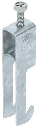
Bügelschelle mit W-Fuß, Metalldruckwanne mit gerundeten Kanten für Kabelschutz. Zur vertikalen und horizontalen Montage von 2 Einzelkabeln an Winkelisen bis < 40 mm. Mit 1-gängiger Schraube an Druckwanne, universeller Sechskant-Schraubenkopf SW10, mit Schlitz und Kreuzschlitz. Geeignet für Montage im Innen- und Außenbereich. Der Einsatz einer Gegenwanne wird empfohlen.
