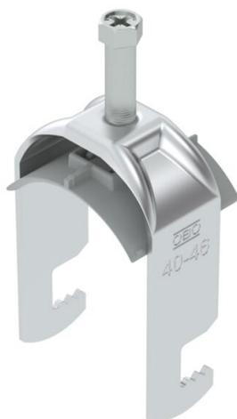
Bügelschelle mit F-Fuß, Kunststoffdruckwanne aus Polypropylen. Zur vertikalen und horizontalen Montage von 1 Einzelkabel an Flacheisen. Mit 1-gängiger Schraube an Druckwanne, universeller Sechskant-Schraubenkopf SW10, mit Schlitz und Kreuzschlitz. Geeignet für Montage im Innen- und Außenbereich. Der Einsatz einer Gegenwanne wird empfohlen.
