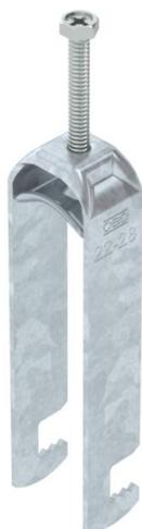
Bügelshelle mit F-Fuß, Metalldruckwanne mit gerundeten Kanten für Kabelschutz. Zur vertikalen und horizontalen Montage von 3 Einzelkabeln an Flacheisen. Mit 1-gängiger Schraube an Druckwanne, universeller Sechskant-Schraubenkopf SW10, mit Schlitz und Kreuzschlitz. Geeignet für Montage im Innen- und Außenbereich. Mehrere Kabel sollten durch Doppelwannen getrennt werden. Der Einsatz einer Gegenwanne wird empfohlen.
