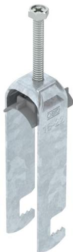
Bügelshelle mit F-Fuß, Kunststoffdruckwanne aus Polypropylen. Zur vertikalen und horizontalen Montage von 3 Einzelkabeln an Flacheisen. Mit 1-gängiger Schraube an Druckwanne, universeller Sechskant-Schraubenkopf SW10, mit Schlitz und Kreuzschlitz. Geeignet für Montage im Innen- und Außenbereich. Mehrere Kabel sollten durch Doppelwannen getrennt werden. Der Einsatz einer Gegenwanne wird empfohlen.
