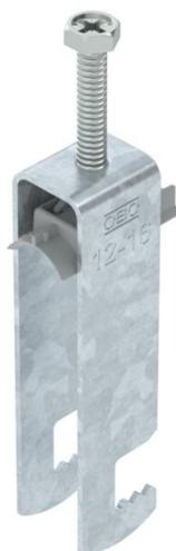
Bügel­schelle mit F-Fuß, Kunststoffdruckwanne aus Polypropylen. Zur vertikalen und horizontalen Montage von 3 Einzelkabeln an Flacheisen. Mit 1-gängiger Schraube an Druckwanne, universeller Sechskant-Schraubenkopf SW10, mit Schlitz und Kreuzschlitz. Geeignet für Montage im Innen- und Außenbereich. Mehrere Kabel sollten durch Doppelwannen getrennt werden. Der Einsatz einer Gegenwanne wird empfohlen.
