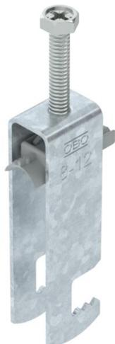
Bügel­schelle mit F-Fuß, Kunststoffdruckwanne aus Polypropylen. Zur vertikalen und horizontalen Montage von 3 Einzelkabeln an Flacheisen. Mit 1-gängiger Schraube an Druckwanne, universeller Sechskant-Schraubenkopf SW10, mit Schlitz und Kreuzschlitz. Geeignet für Montage im Innen- und Außenbereich. Mehrere Kabel sollten durch Doppelwannen getrennt werden. Der Einsatz einer Gegenwanne wird empfohlen.
