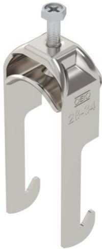
Bügelschelle mit W-Fuß, Metalldruckwanne mit gerundeten Kanten für Kabelschutz. Zur vertikalen und horizontalen Montage von 1 Einzelkabel an Winkelisen bis < 40 mm. Mit 1-gängiger Schraube an Druckwanne, universeller Sechskant-Schraubenkopf SW10, mit Schlitz und Kreuzschlitz. Geeignet für Montage im Innen- und Außenbereich. Der Einsatz einer Gegenwanne wird empfohlen.
